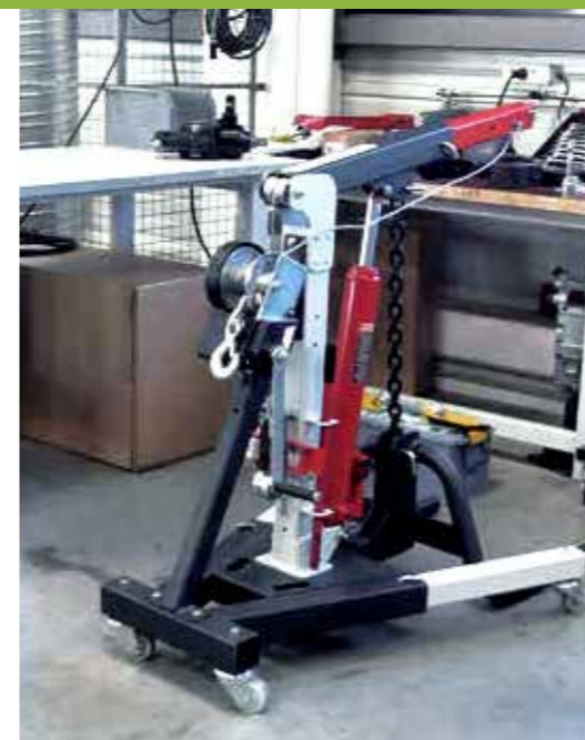
Depuis trois ans, Gys conçoit et fabrique des équipements de levage pour les ateliers de la réparation automobile/poids lourds, afin de les aider à la manutention de charges lourdes comme des roues et des disques de frein. Ici zone de test.
