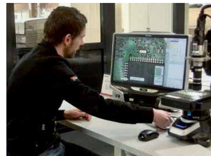
Ce microscope qui grossit deux mille fois permet, par exemple, de contrôler des micro-soudures sur des cartes électroniques.
